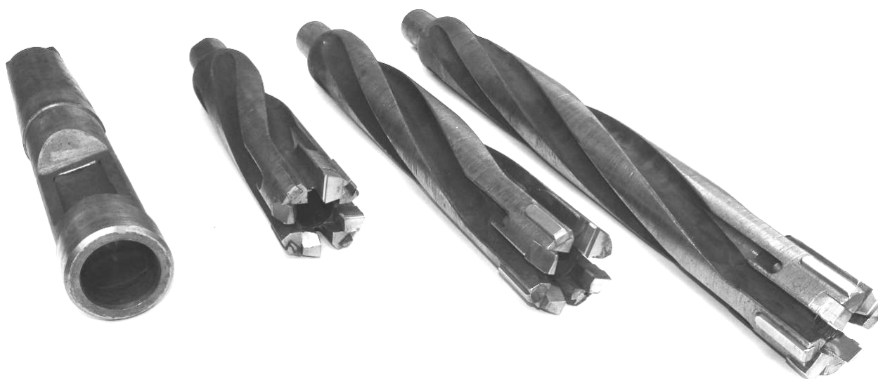
Рис. 3. Оправка для излома стержня и комплект кольцевых свёрл, применяемые при взятии проб на глубине 500 мм
